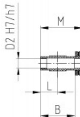
Допуск для концов вала: h7 глубина неровности профиля  $\leq R_a = 16$  необх. предел растяжения материала вала  $R_m \text{ мин.} = 375 \text{ Н/мм}^2$
