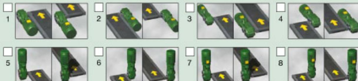
Допустимый наклон: двигатель внизу 25°, двигатель сверху 12° • Установочное положение 5 - 8: двигатель с навесом от дождя
